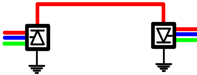
Figur 3 Monopol med elektrodeanlegg
